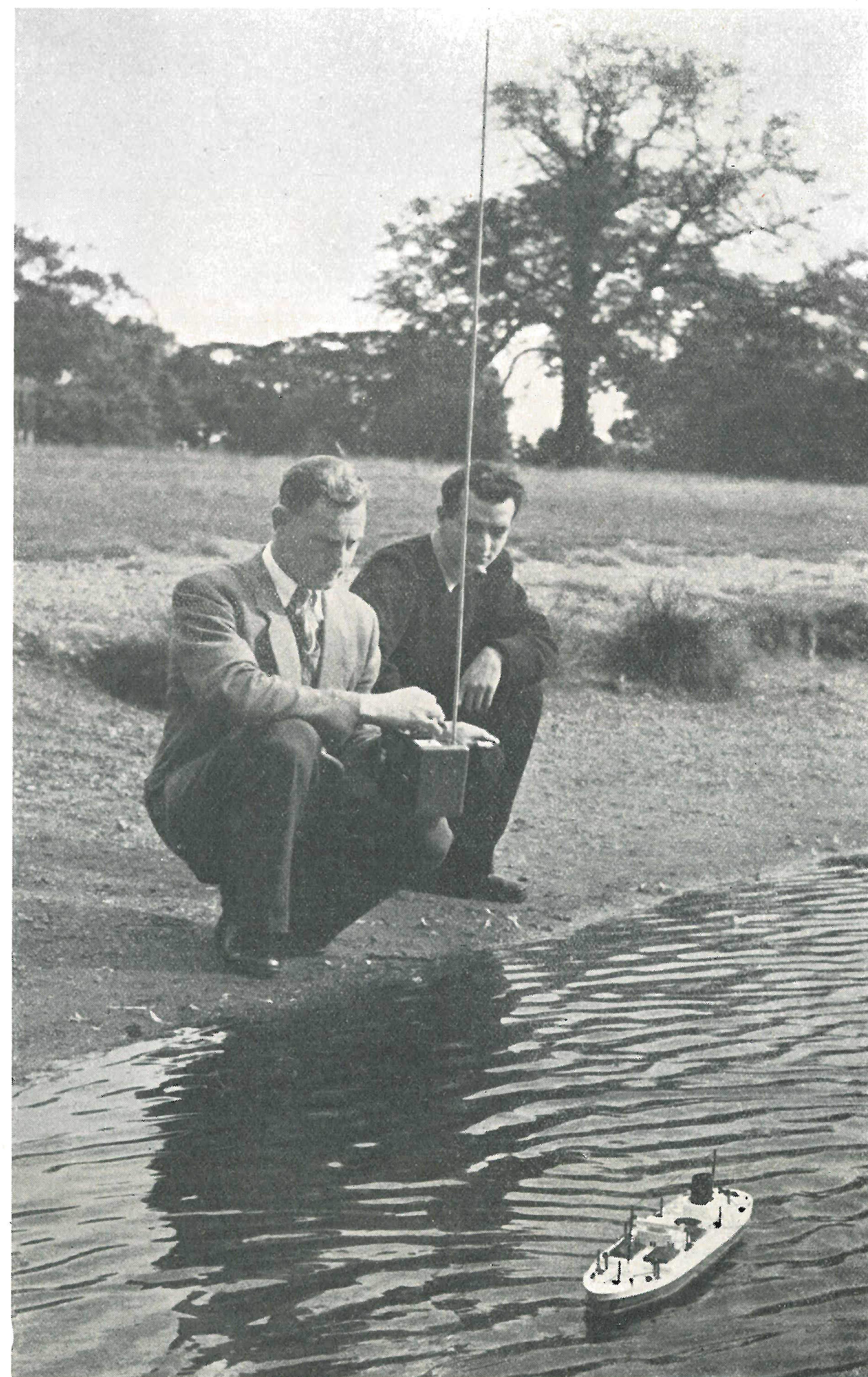
Le manovre del piccolo battello sono comandate da un trasmettitore radio portatile, realizzato dalla Lines Brothers Ltd., di Richmond. Distanza massima di comando, circa 150 metri.
